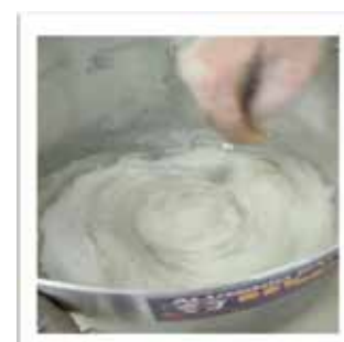
Figura 5. Adición de cloruro de sodio
