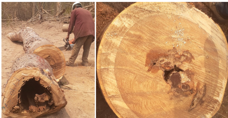
Figura 2. Colección y selección de muestras transversales de la especie en estudio. El lado izquierdo saneado de una troza en busca de la parte más sana y derecho una rodaja infectada por hongos principalmente en la zona medular y cercano a la superficie del suelo en los bosques Chiquitanos de CIMAL.
