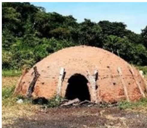
Fig. 3. Horno tipo media naranja construido a base de ladrillo y barro.
